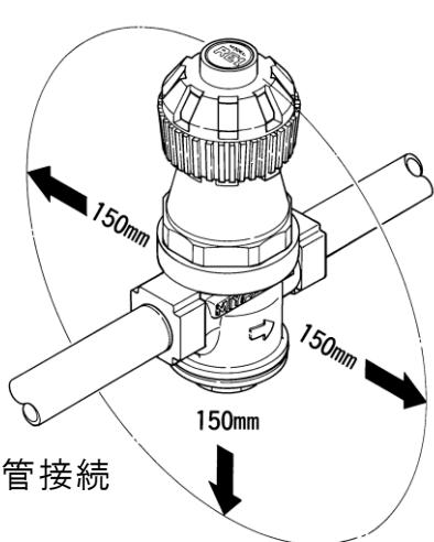
作業有効スペースの寸法は、配管接続
