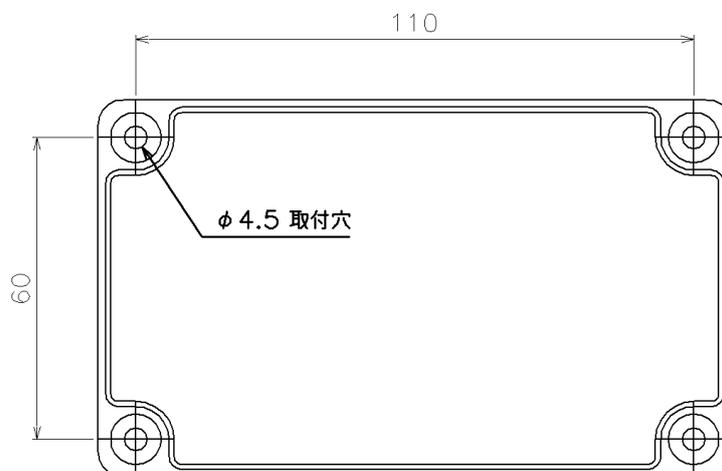
制御ボックス取付寸法図
